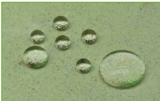
Гидрофобизация: придание строительному материалу водоотталкивающих свойств.
